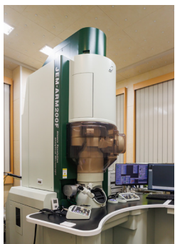
0.08nmの分解能を有する走査透過型電子顕微鏡。原子レベルの分解能で物質を観察することが可能
