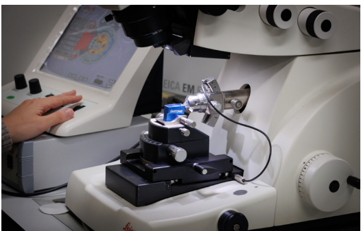
透過電子顕微鏡観察用の薄片試料を精密に作製できるウルトラミクロトーム。中央の青色の部分がダイヤモンドナイフ。低温での切削も可能
